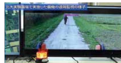
AIが判断してパトライトを点灯。さらに近づくと、自動的に停止する。
