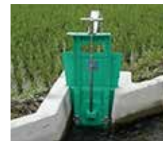
開水路で使用される自動給水装置。自動的にゲートを閉めて止水する。
