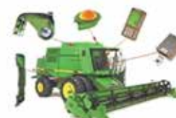
コンバインに装着されたセンサ
