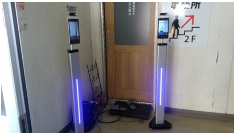
●非接触型検温器（サーモグラフィーカメラ）の設置
