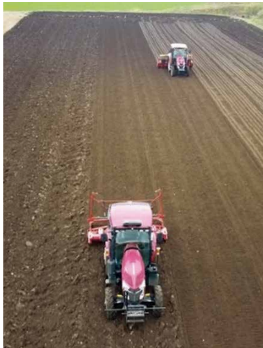
写真14 手前がロボットトラクター、奥が播種作業中の有人トラクター
