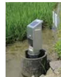
タイマー式の自動給水装置。
