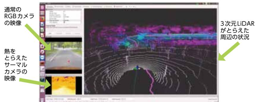
LiDARやGPS等のセンサによって、対象となる環境の高精度3次元地図を作成
