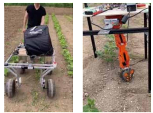
搭載されているセンサカメラによって、畝沿いを時速1kmで走行するロボット(写真左)。マニピレータの実演では1回失敗したが、再度トライすることで雑草を除去した(写真右)。
