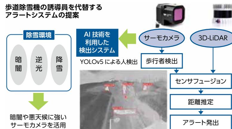
暗闇や降雪、逆光などの悪環境において、AIと組み合わせたサーモカメラで人を検知、またLiDARで距離を測定してアラートを発出する。北大の研究室では小型除雪機の自動運転技術として開発されているが、将来の小型ロボット農機の安全性にとっても不可欠な技術といえる。
