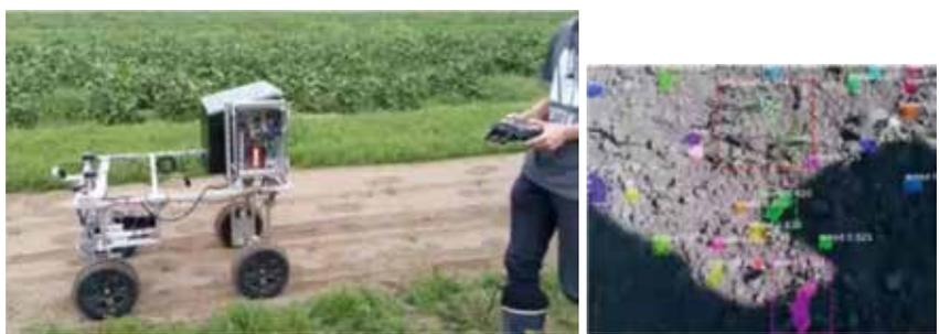
車両速度は時速1km(写真左)。この速度で移動しつつ、80%の精度でハトムギと雑草を識別した(写真右)。精度を90%にまで上げ、1秒間に10回識別できれば、十分に実用的になると考えられている。
