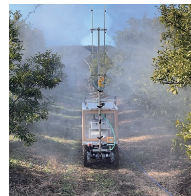
モバイルムーバーによる農薬散布
