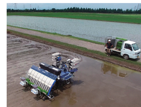
監視のもとに稲の苗を植え付けるロボット田植え機
