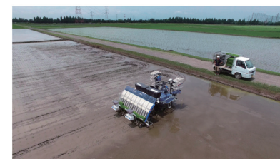
監視のもとに稲の苗を植え付けるロボット田植え機
