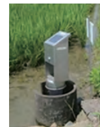
タイマー式の自動給水装置。
