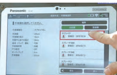
写真10 作業機としてサブソイラを選択
