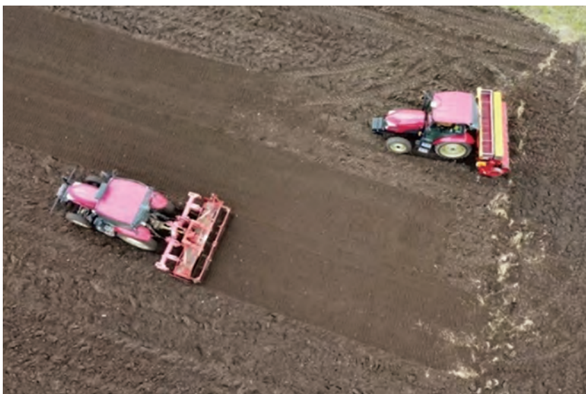
写真13 無人のロボットトラクターが整地作業を行う後ろから、播種を行う有人トラクターが追走する
