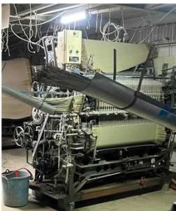
い草生産農家の 冠水した織機の修繕
