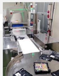
品質向上のための金属探知機・X線検査機
