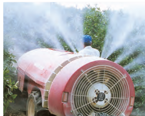
▲病気や害虫からくだものを守るための作業。スピードスプレーヤーで、薬剤をまく。(写真では水をまいている)
