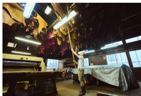
なめしたあとの革は、乾燥室でよく乾燥させた後、縮んだ繊維を平らに伸ばし、製品加工のしやすい状態にします。
