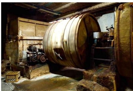
汚れや塩分を落として毛を分離させた後の皮を、なめし剤と共に大きなドラム槽に入れ、グルグルと回転させます。
