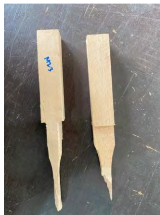
写真 23 マホガニーの繊維方向に平行な引張試験
