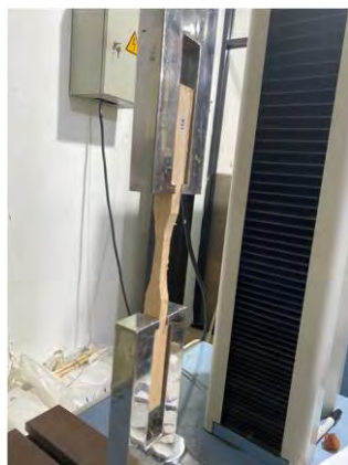
写真 23 マホガニーの繊維方向に平行な引張試験
