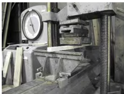
写真 24 ゴム材の曲げ試験状況
