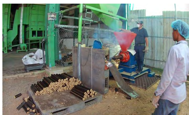
図 IV-27 木くず混入固形燃料製造実証の様子
