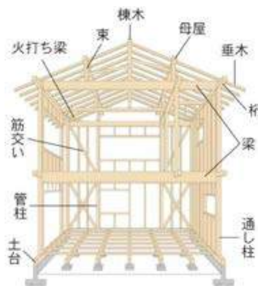
図 IV-8 木造軸組工法
