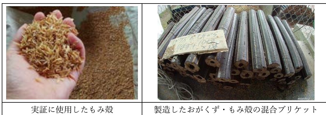
図 V-7 おがくず・もみ殻混合のブリケット製造
