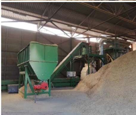
【写真：Atlant社ペレット工場】 山積みになっているオガ粉を乾燥、プレスし、ペレットに加工する
