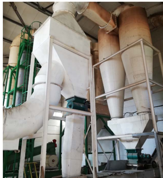
【写真：Atlant社ペレット工場】 山積みになっているオガ粉を乾燥、プレスし、ペレットに加工する
