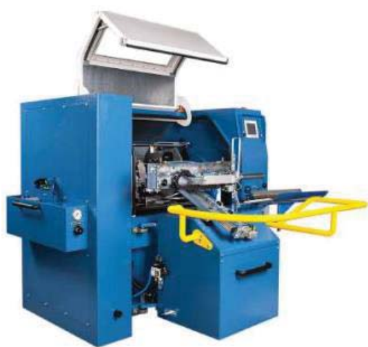
ROBLON 製 三つ編み・四つ編み用機械 鉛の錘つきを含む
