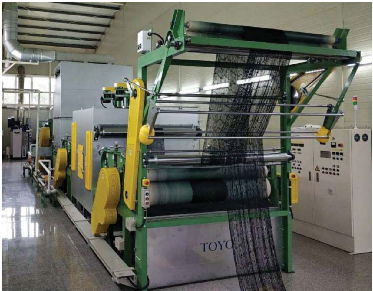
漁網の染色、含浸、仕上げを行えるTOYO製の機械
