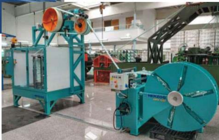
8つ編み、12編みロープ用機械 ROBLON 製、HERZOG 製
