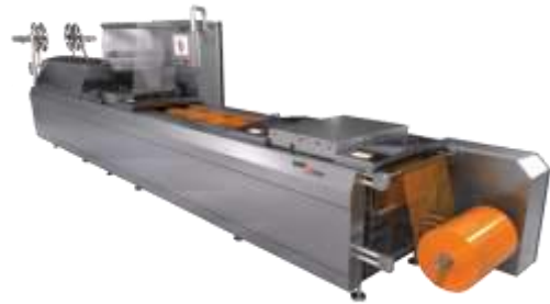
聞き取りの中で、多くの乳業会社及び食肉会社から、迅速で高品質な包装機として言及が多かったのは、上記の真空成型包装機である（VC999 I-シリーズ 出所）Wikipedia
