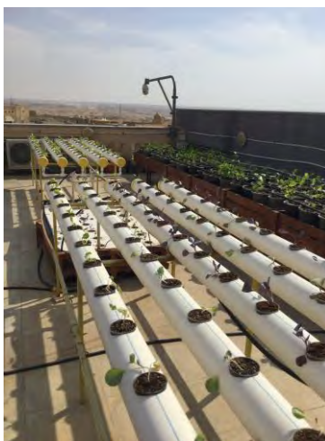
PPパイプを使った野菜栽培実験装置
