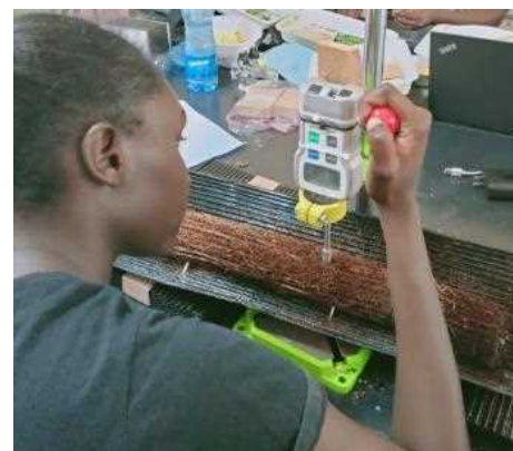
図 3-20 根鉢硬さの測定の様子
