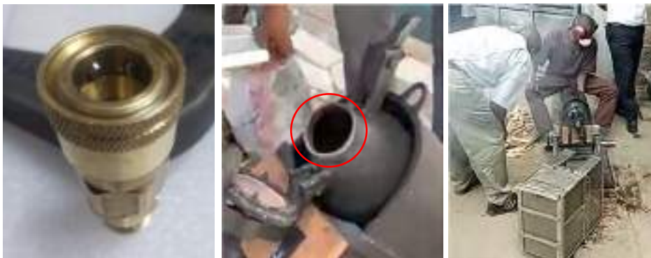
（圧漏れのあったカップラー（左）、圧漏れのあったシリンダー口（中央）、検査風景（右））
