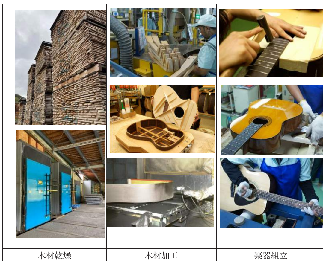
図 IV-8 木工加工・楽器生産工程
