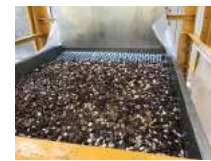
サチャインチの種の殻を除去する機械
