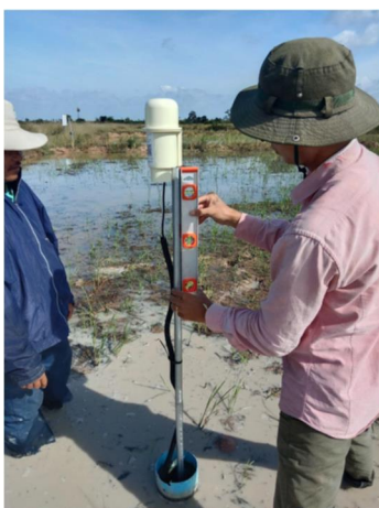
写真-2 機器設置状況（左：通信基地局、中央：水位センサー、右：paditch 設置後（いずれもカンボジア）
