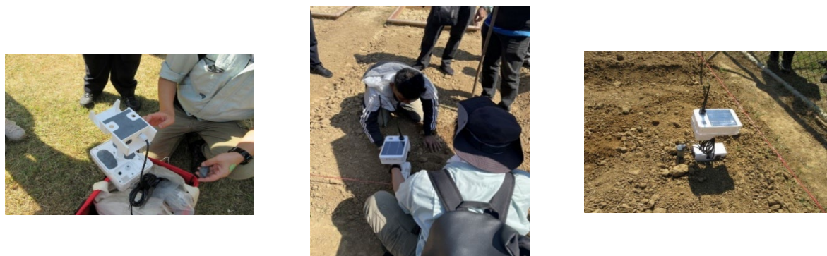
写真 1 露地センサの設置（左） 粘土での隙間埋め完了（中・右） 試験区画へのセンサの埋設
