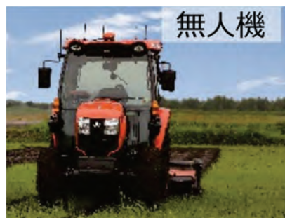
図-4.11.2 ローカル 5G を利用した遠隔監視による自動走行農機の導入事例 2)
