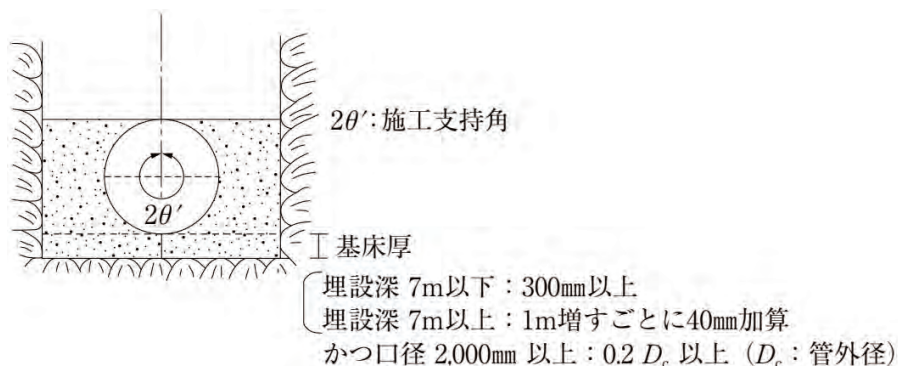
図-4.6.5 岩盤の場合の基礎工
