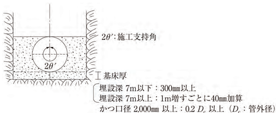
図-3.6.5 岩盤の場合の基礎工
