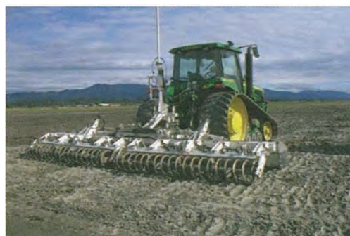
写真-5.3.1 運土量削減型整地工法による作業状況（左：表土と下層土の反転、右：運土・整地）
