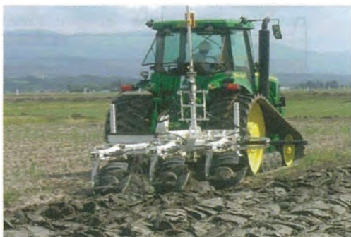
写真-5.3.1 運土量削減型整地工法による作業状況（左：表土と下層土の反転、右：運土・整地）
