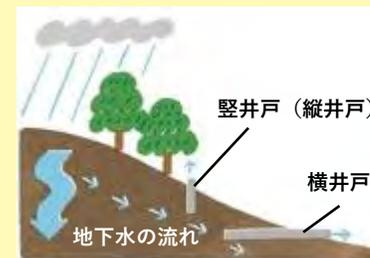
横井戸掘の技術は、生活用のトンネル掘りにも活かされています。国道トンネルの横に当時の手掘り隧道「中山隧道」が保存されています。
