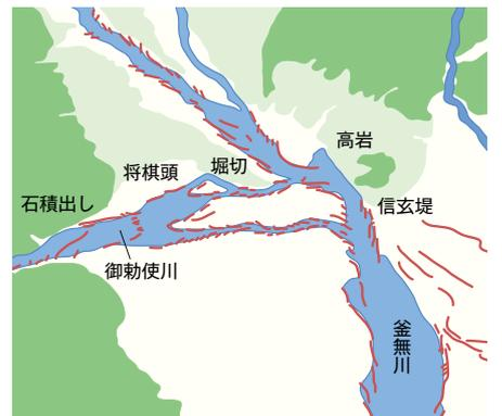
図1-1 武田信玄の治水工事の全体図
