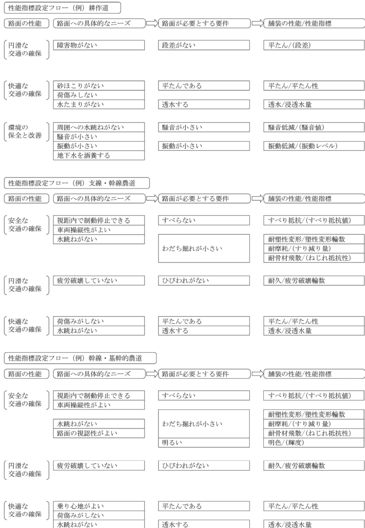
図-7.2.3 車道及び側帯の舗装における性能指標の例
