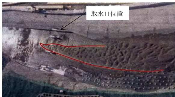
写真-9.6-4 洪水発生後の模型状況（水制工なし）
