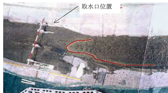
写真-9.6-5 洪水発生後の模型状況（水制工あり）
