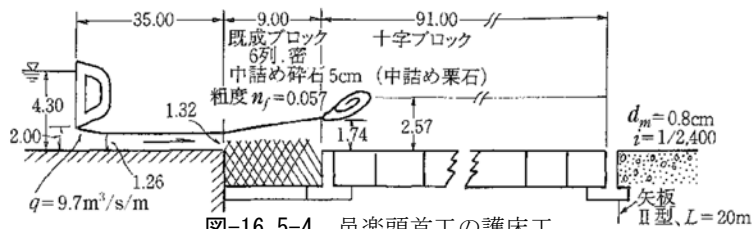
図-16.5-4 邑楽頭首工の護床工
