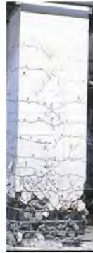
①S20試験体(曲げせん断耐力比 2.51, 曲げ破壊)
