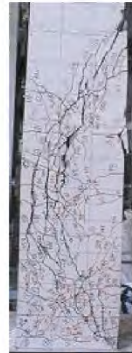
②S10試験体(曲げせん断耐力比 1.08, 曲げせん断破壊)
