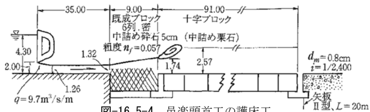
図-16.5-4 邑楽頭首工の護床工
