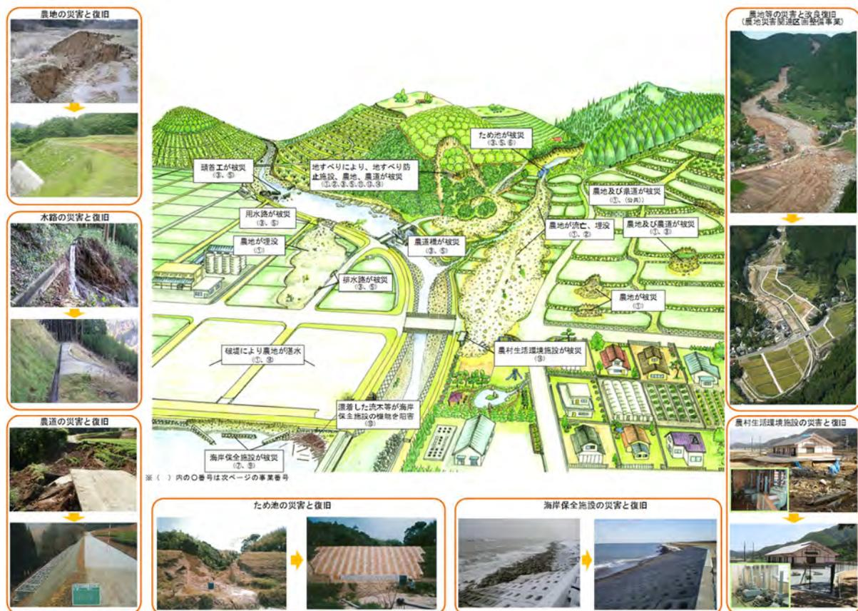
図2-1 主な農地・農業用施設などの被害と災害復旧
