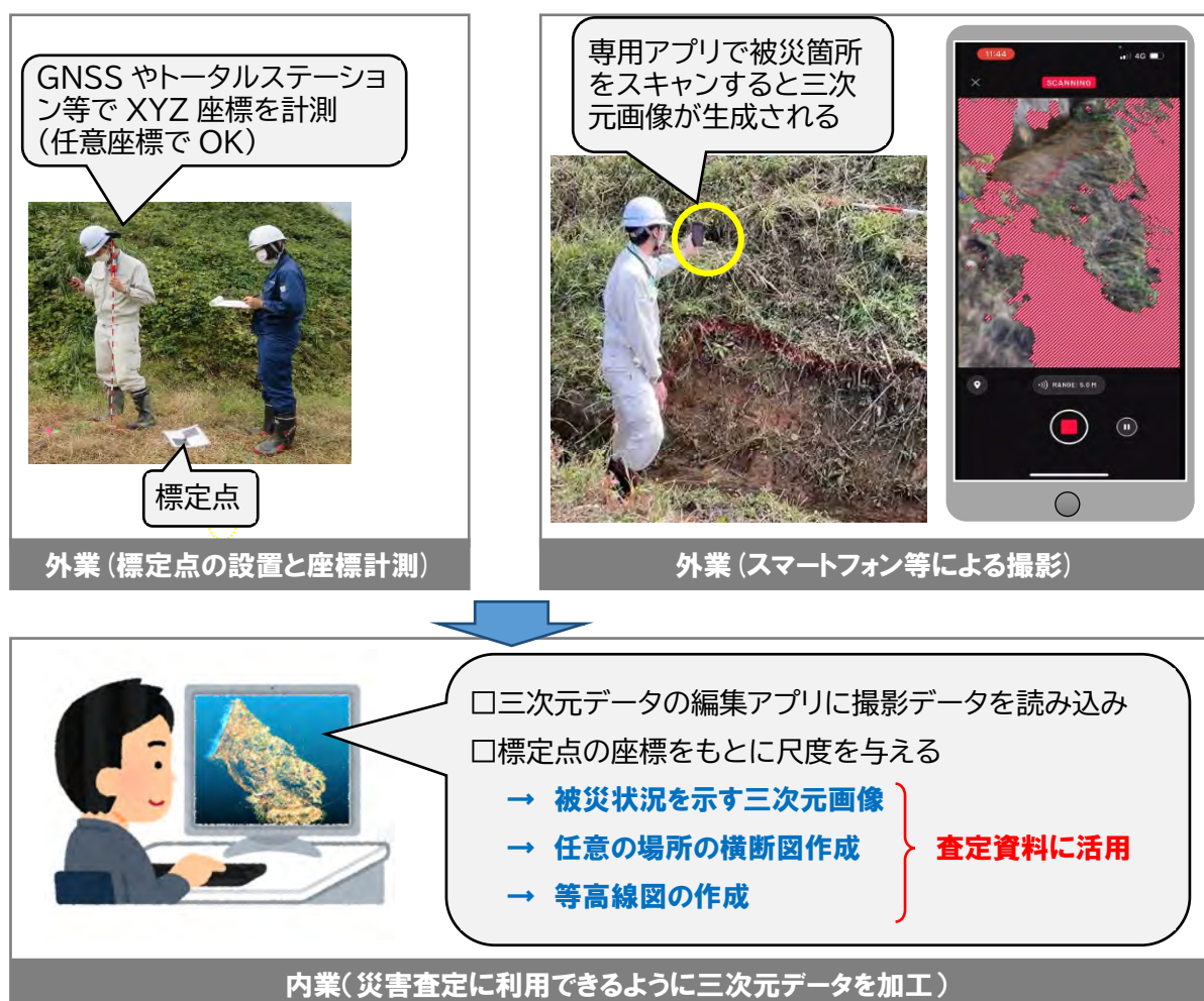
図 3-17 スマートフォン等を用いた三次元測量の作業の概要(アプリによっては手順・内容が異なる)
