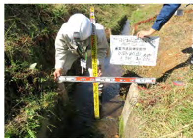
図3-5 水路断面の計測状況(2名で対応可能)
