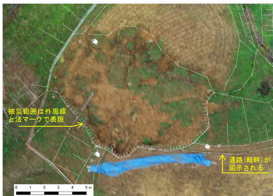
図 3-7 従来の測量成果(農地被災現場、被災部分拡大)
