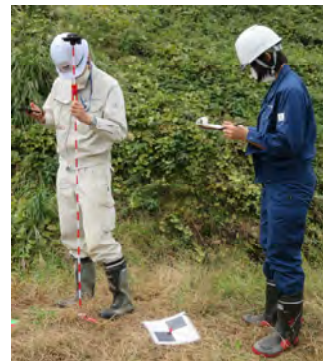
図4-13 安価なGNSS(ビズステーション(株) RWP)と作業風景
