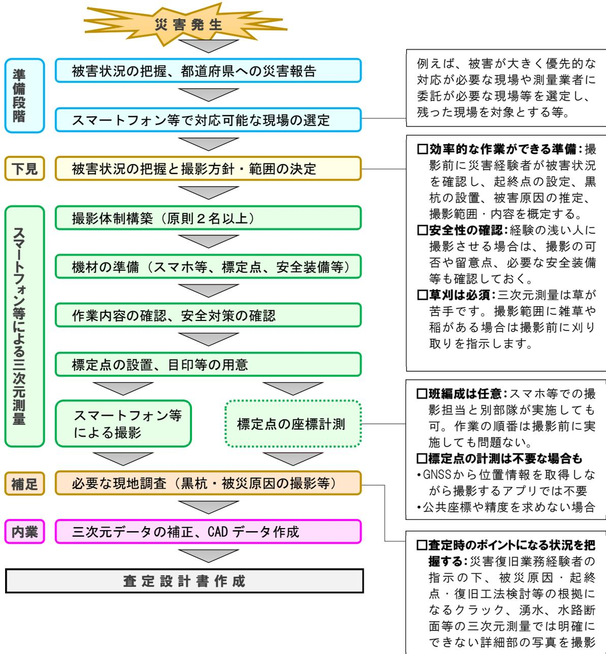
図3-17 スマートフォン等を用いた三次元測量の実施手順の例 パターン①
