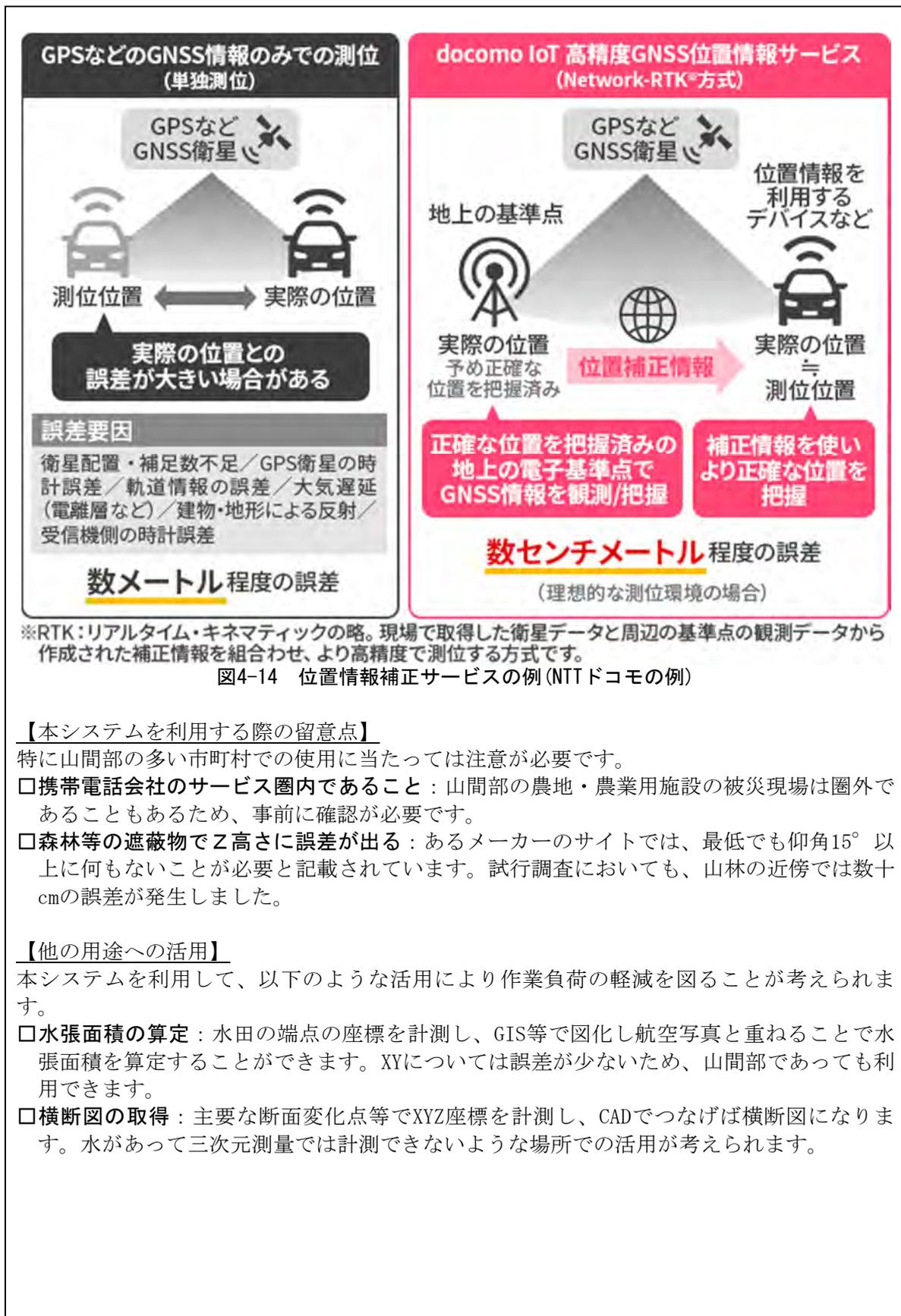
図4-14 位置情報補正サービスの例 (NTTドコモの例)
