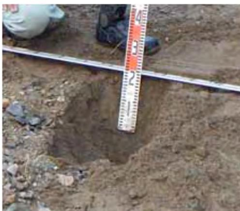
図4-20 堆積土砂厚の計測例
