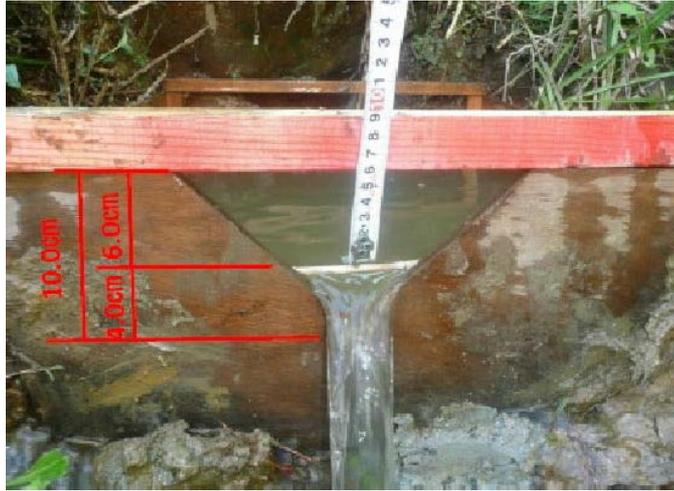
写真 2-8-5 三角堰による漏水量調査
