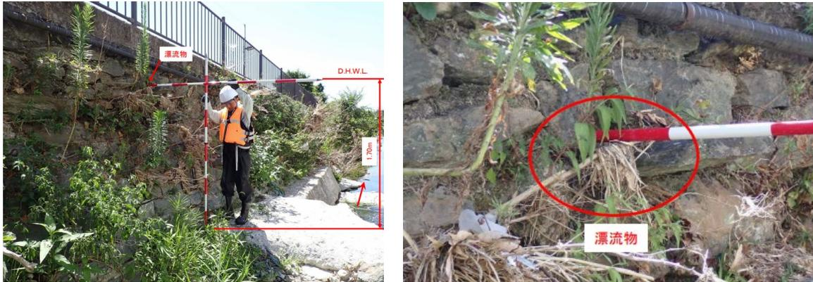
写真 2-2-1 洪水痕跡河川出水状況表
