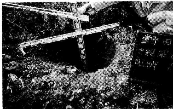
写真 2-7-2 干ばつによるき裂深測定状況
