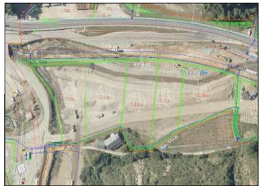
2) 工事用図面との重ね図【被災後】
