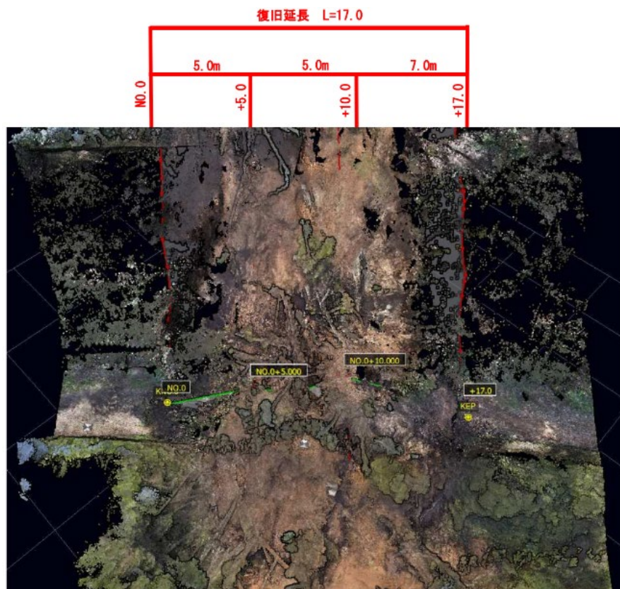
写真 2-12-6 道路幅員及び横断写真（三次元点群による計測データその 3）
