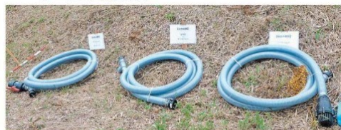
サイホンの原理を活用した排水装置のホース。右は池に入れる「吸い込み口部」、中央は水を注ぐ「注水口部」、左は「吐き出し口部」
