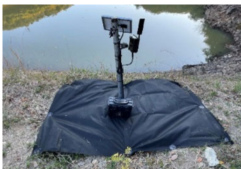
②防草シートの設置
