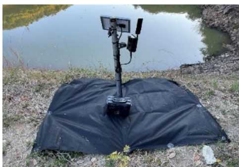
②防草シートの設置
