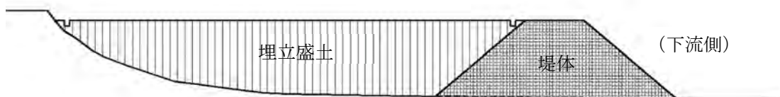
図-3.3 埋立工法（縦断イメージ）
