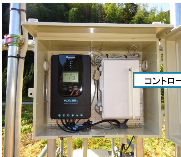
ソーラーチャージコントローラー 観測データ収集とLoRaWAN
