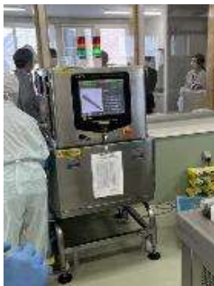
金属探知機と0.5mmまで検出可能なX線異物検出機で異物混入を防止
