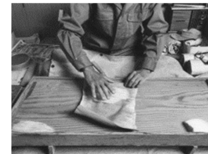
伝統的な製法による熊野筆の製造 (火のし・毛みみの工程)
