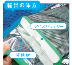
温度変化に弱い野菜等を保冷するためのアイスバッテリー。内部の溶液の成分割合により2度単位で温度の調整が可能。リース料が発生するが、保冷車よりも輸送コストを下げるができる。
