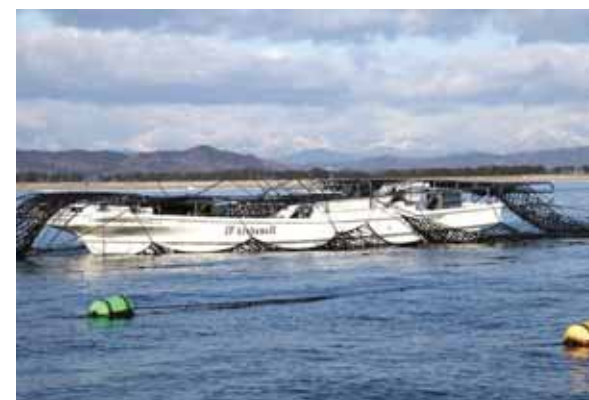
たった1人で効率的な作業を実現、自動で摘み取る海苔養殖システム船
