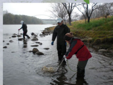
エアスコップ:コンプレッサから送られる圧縮空気て根ごと除去
