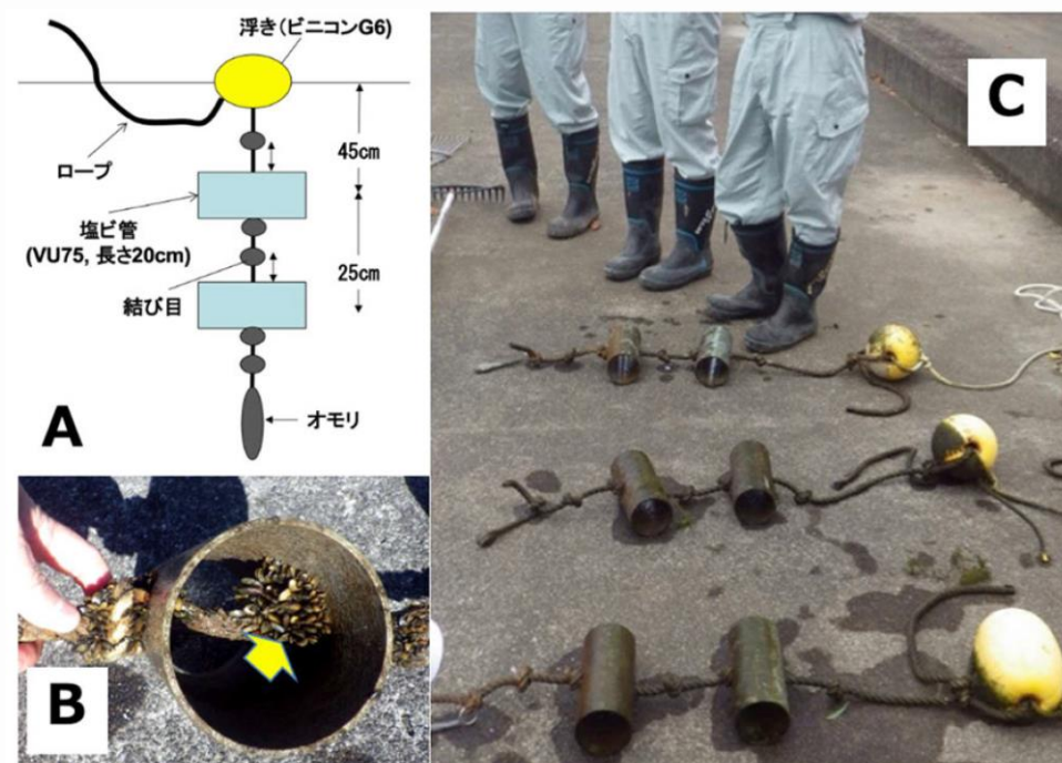
図 89 塩ビ管とロープを用いたカワヒバリガイ付着トラップの例 (A: 仕様の一例、B: 付着したカワヒバリガイ (矢印)、C: 回収された付着トラップ)
